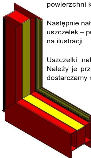
EI30 – jedna warstwa uszczelki
